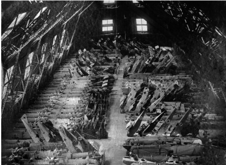
Der Innenraum der mit Flugwerken gefüllten Zeppelin-Halle in Winiary bei Posen. Es sind die Rümpfe u.a. der Albatros-Flugzeuge B.II, AEG C.IV, AEG N.I und LVG C.V zu sehen. Fot. aus den Sammlungen der CBN „Polona“
